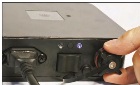
5.1 Dévissez le capuchon à côté de l'interrupteur.
