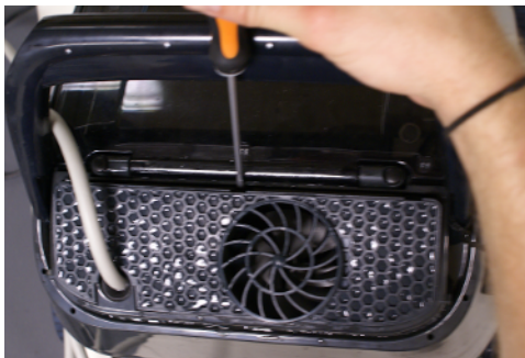
8.1. Utilisez un tournevis plat pour retirer la grille de protection.
