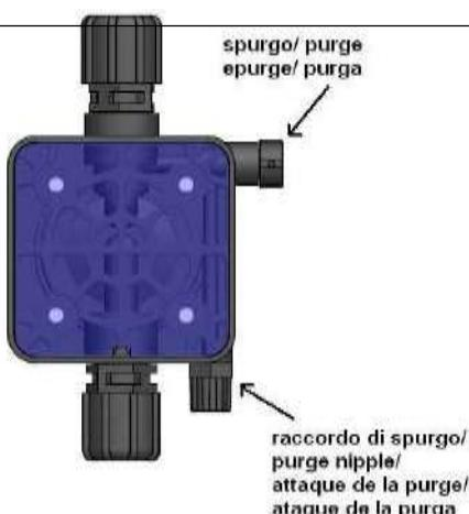
**I** -Svitare di mezzo giro la manopola di spurgo (in alto a destra del corpo pompa)
